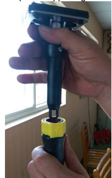
Stützkopf austauschen Replace supporting head
