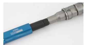
Dichtring mit Kompressionswerkzeug komprimieren
