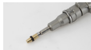
Kurzen Montagekegel und Dichtring auf Injektor setzen
