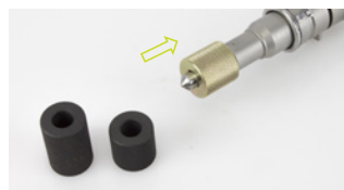
Hülsen von A bis C auf Injektor schieben
