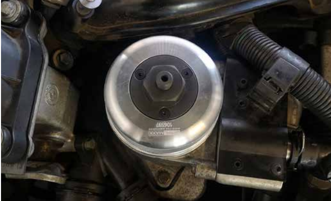
ÖLFILTERADAPTER 106597 BEI BMW N46
